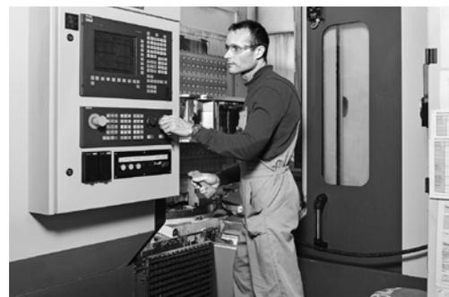
5 An diesem den Vorschriften entsprechenden Bearbeitungszentrum darf nur im Normalbetrieb alleine gearbeitet werden. Für die Behebung von Störungen, für den Werkzeugwechsel und für Instandhaltungsarbeiten muss eine Sicht- und Rufverbindung zu einer zweiten Person bestehen.
